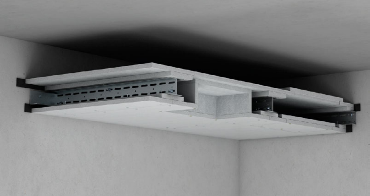
Wandanschluss - Querschnittschnitt Wandanschluss - Längsschnitt
